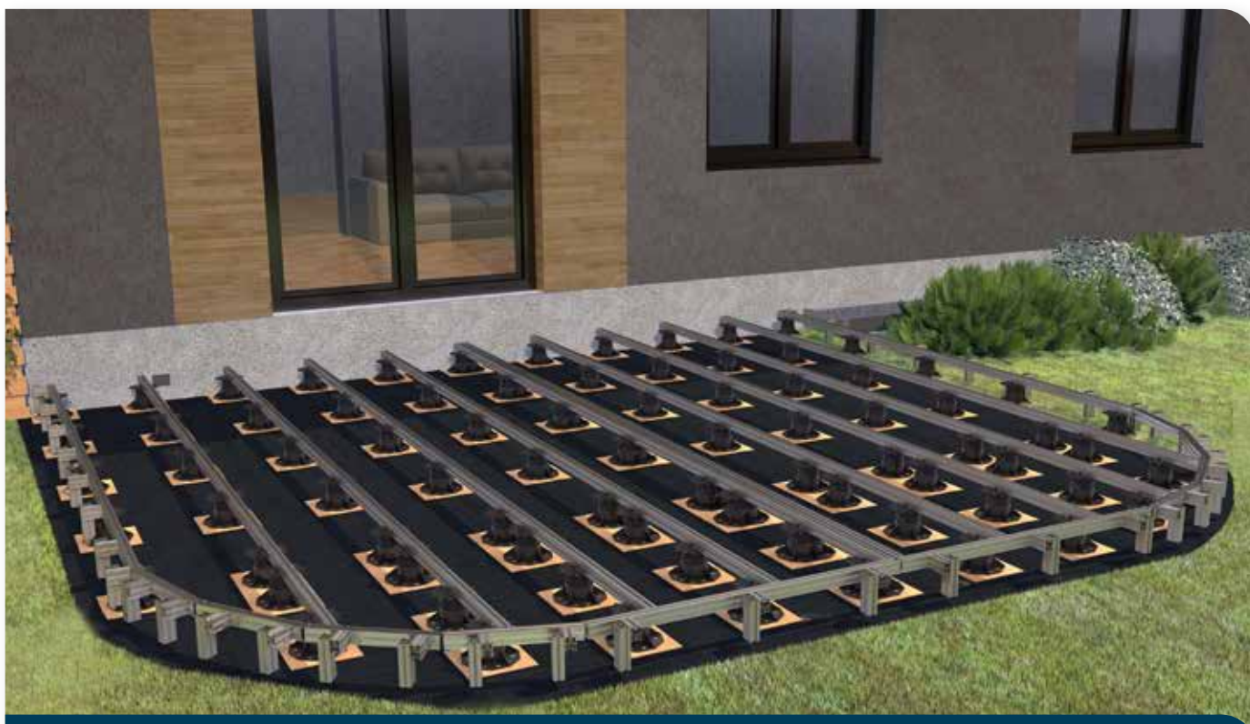
Aufbau Aluminium-Unterkonstruktion für verrundete Terrasse
