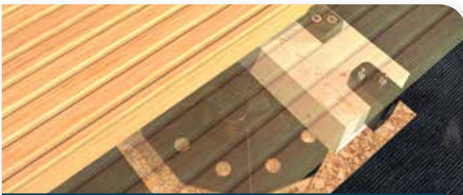
Schritt 5: Letzte Diele mit dem Plankfix Angle befestigen
